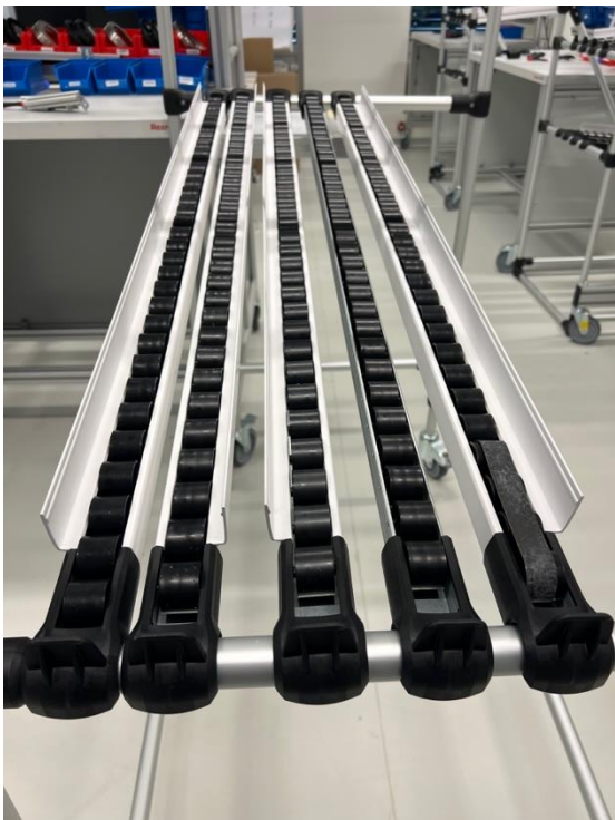
Abbildung 7: Nahaufnahme der Rollbahnen (mit Bremsen)
